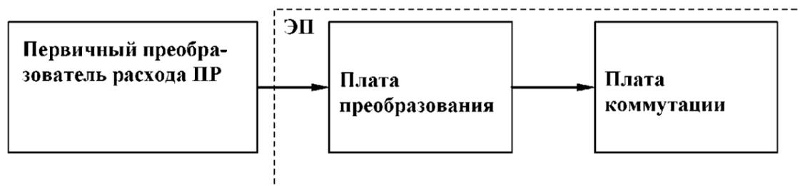
Рисунок 1 - Структурная схема датчика расхода.
